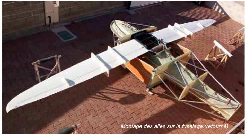
Montage des ailes sur le fuselage.(retourné)
