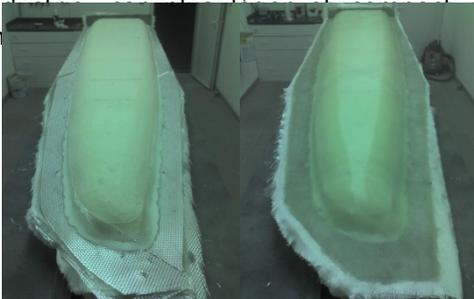
La seconde demi-coquille est réalisée de la même façon, après avoir retourné la pièce et retiré la plaque outillage de séparation.
