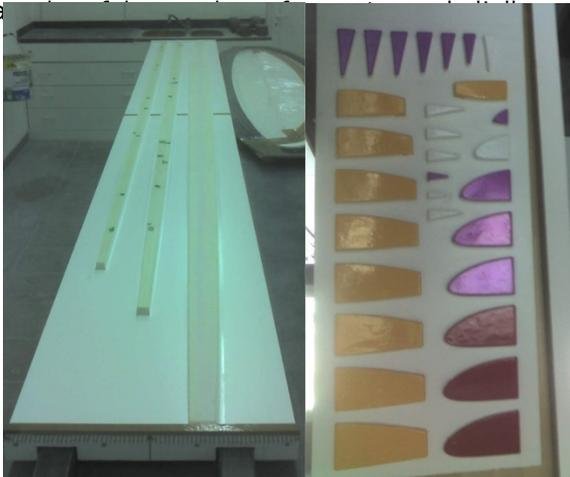
L'autre champ de ces masters est apposé sur une plaque servant de support à la stratification du moule au-delà des pièces à mouler. Plusieurs masters peuvent être rassemblés sur une même plaque pour n'avoir qu'un seul grand moule commun à réaliser.
