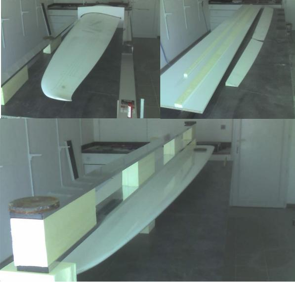
Une fois extraite, la hauteur de ces tranches doit être réduite de l'épaisseur prévue des futures peaux composite de l'aile.
